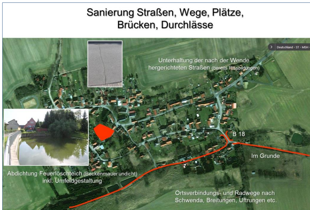
Abbildung 62: Sanierungsbedarf Straßen und Brücken im OT Dietersdorf
