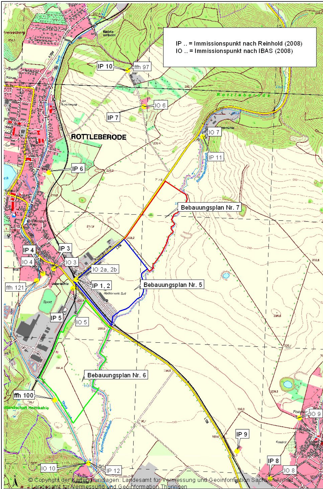
Abbildung 3.1-1: Immissionspunkte nach Reinhold (2008) und IBAS (2008); (ohne Maßstab)
